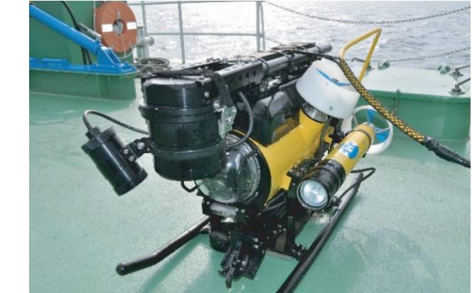
写真1 有策型水中ロボット（ROV）
