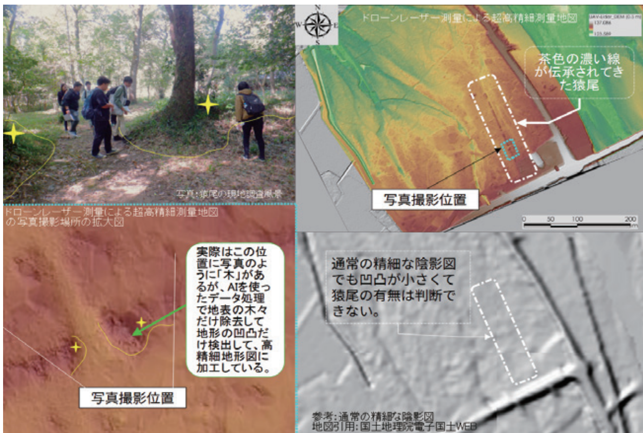
図1 猿尾の高精細測量（図提供：小倉拓郎氏）
