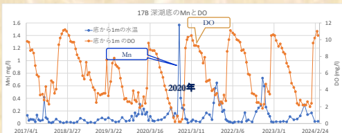
図4 琵琶湖北湖17Bにおける深湖底(水深90m)のDOとMnの経月変動。
