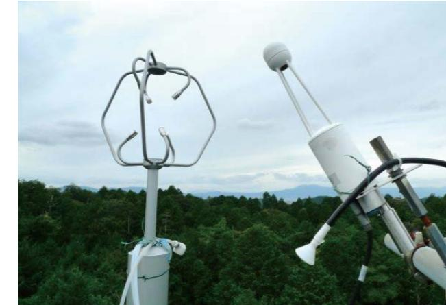
写真2 超音波風速温度計（左）とCO<sub>2</sub>/H<sub>2</sub>O分析計（右）（京都大学・桐生水文試験地）。この二つの分析計を利用して、CO<sub>2</sub>吸収速度と蒸発・蒸散速度を計測する。
