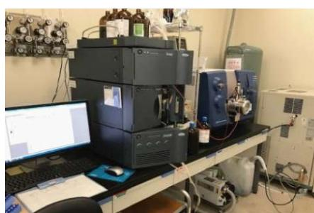
写真1 液体クロマトグラフ質量分析計 (LC/MS)
