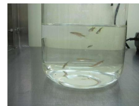
写真3 ゼブラフィッシュを用いた急性毒性試験の様子
