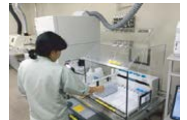
誘導結合プラズマ質量分析計 (ICP/MS) による金属類の分析
