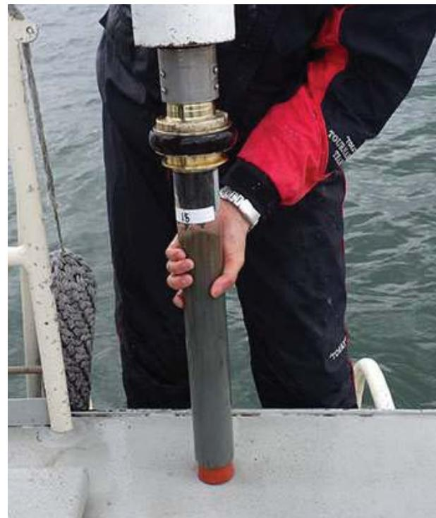
図 2-3 重力式コアサンプラーとアクリル製カラムによる採泥の様子
