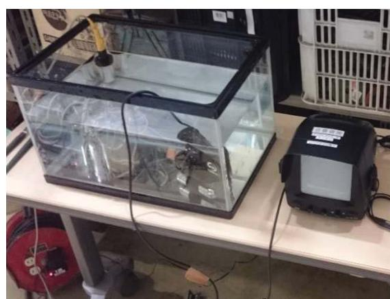
写真 1 アンデールヨコエビの遊泳角度測定
