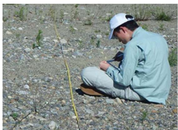
写真 5-1 測線における線格子法による粒径測定の様子
