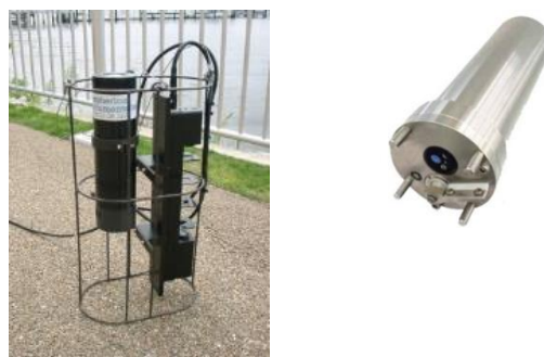
写真 3.1 [左] 透過型濁度計 (装置右部) と [右] 散乱型濁度計
