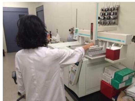
写真3 GC-MSによる1,4-ジオキサン分析の様子
