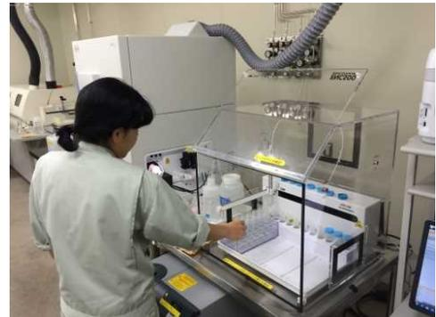
写真 1 ICP-MS による鉛分析の様子
