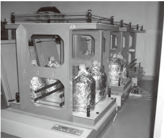
図6 湖水および河川水の生分解試験の状況 (グラビア1頁参照)
