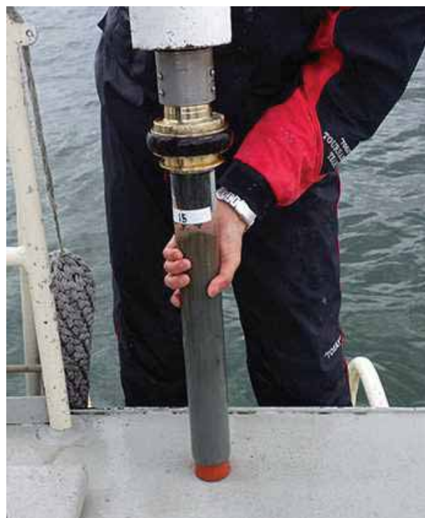
図3-2 重力式コアサンプラーとアクリル製カラムによる採泥の様子
