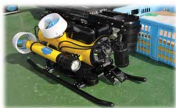
図 3-2 有索式水中ロボット (ROV)
