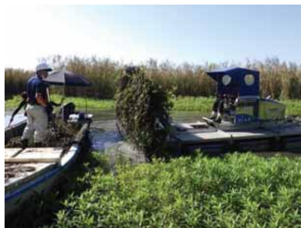
図2-4 機械駆除に用いられた水陸両用の水草刈取り船と駆除の様子
