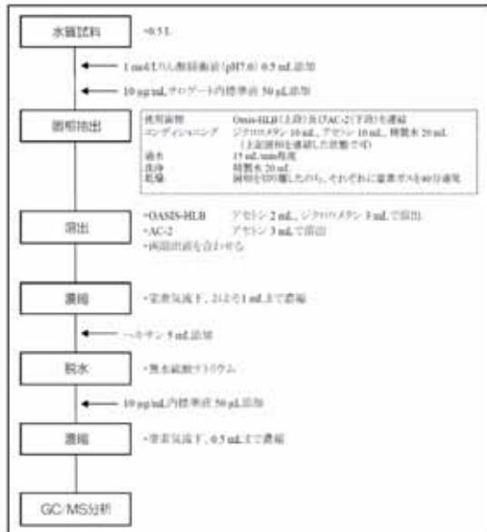
図 2-6 固相抽出法による分析法チャート
