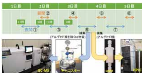
図 3-1-1 VOC 昼夜連続測定の概略図
