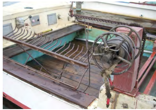
図3 水草除去に用いた貝曳き漁具マンガン
