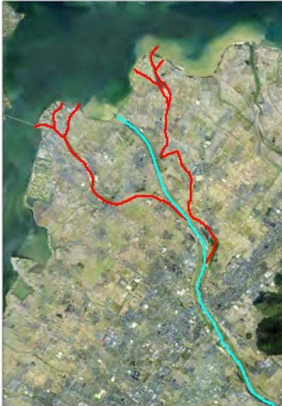
図10 野洲川の流路変更(青が現在の流路。赤は野洲川放水路ができる前の流路。)
