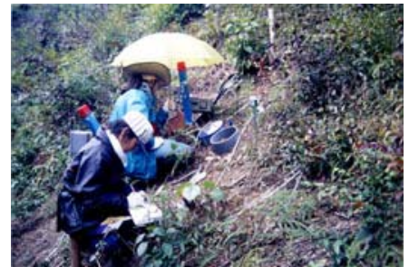
写真1 土壌呼吸速度の調査風景。土壌呼吸速度は、単位面積・単位時間あたりのCO 2 放出量で表されます。観測地点に設置したセンサーによって、土壌水分と地温をモニタリングしています。
