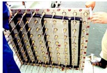
図3 琵琶湖赤野井湾で、硝酸カルシウムを用いた新しい底泥改善技術の開発を始めました。この手法の特徴は、底泥を直接酸化することです。写真は、試作した注入装置ですが、ノズルの先端から硝酸カルシウムを底泥に注入します。
