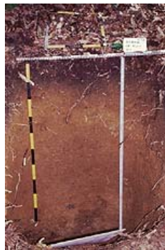
森林土壌の断面：森林土壌の表層近くは黒い色をし、有機質や栄養塩類が蓄積していることがわかります。また、こうしたスポンジ状の土壌は水を蓄える保水能力を持ち、降った雨を溪流にゆっくりと流し出します。(朽木の試験地で、1994年7月20日撮影)
