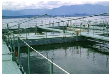
アオコの発生の謎を探るために赤野井湾に設置された隔離水界実験施設(1995年、夏)。湖の一部をシートで囲んでミニ琵琶湖を作り、その中の環境条件を変えてアオコ発生に対する影響を調べる
