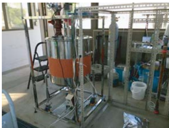
図 3 水草メタン発酵実験槽 200 L
