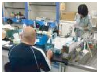
化学的酸素要求量(COD)および浮遊物質(SS)の分析の様子(手前:COD、奥:SS)
