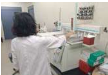
ガスクロマトグラフ質量分析計(GC/MS)による揮発性有機化合物の分析
