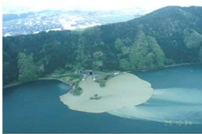
写真 1 西野放水路から塩津湾に流入する外部負荷(濁水)
